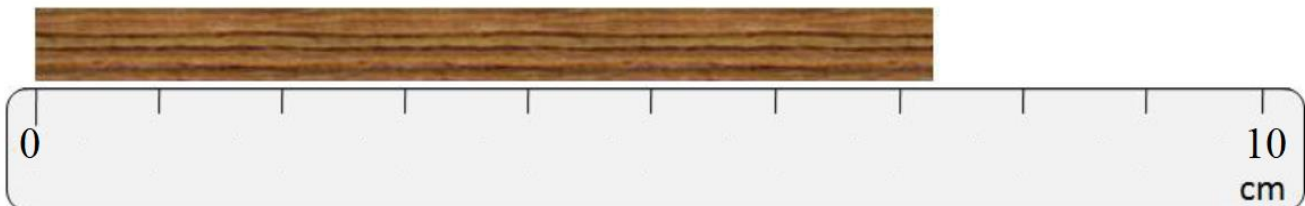
Medición directa de un objeto realizada con una regla graduada en centímetros. Fuente: (Pérez & Weigandt, 2013)
